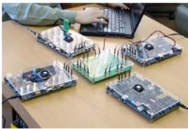
FPGA эмулятор беспроводной сети из 4-х узлов (базовая станция, две релейных станции, пользовательская станция)
