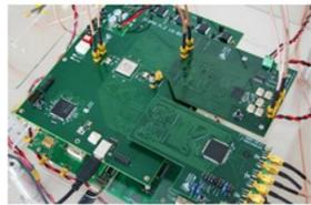
Система на основе FPGA для цифровой обработки сигналов с шириной полосы канала 1 ГГц
