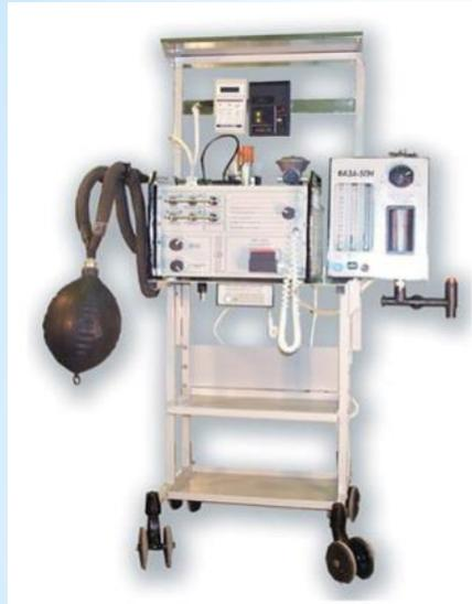
Предназначен для использования в отделениях анестезиологии и реанимации. В комплект входят непосредственно аппарат ИВЛ, наркозная приставка, увлажнитель, адсорбер CO<sub>2</sub>.
